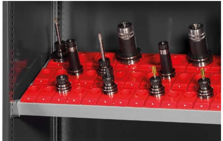
DIE RAHMEN SIND HÖHENVERSTELLBAR UND KÖNNEN HORIZONTAL / SCHRÄG MONTIERT WERDEN.
