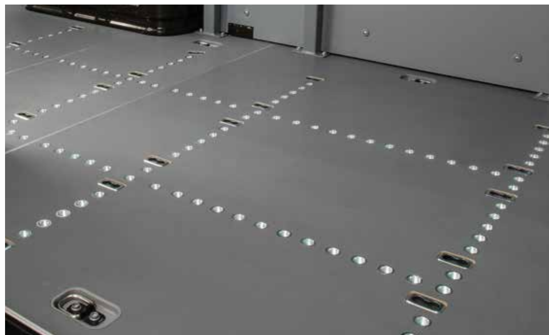
SAFETY CROSS: Fixierpunkte in Längs- und Querrichtung nach Anfrage. SAFETY CROSS: longitudinal and transversal fixing points upon request.
